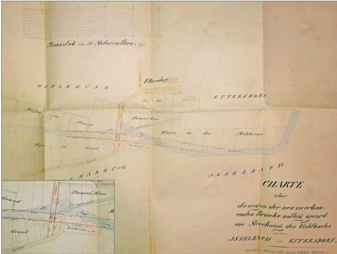
Charte über die wegen der neu zu erbauenden Brücke nöthig gewordene Streckung des Giehlbachs zwischen Isselbach und Ettersdorf. Der Lageplan von 1843 dokumentiert die Begradigung des Gewässers.<sup>84</sup>
