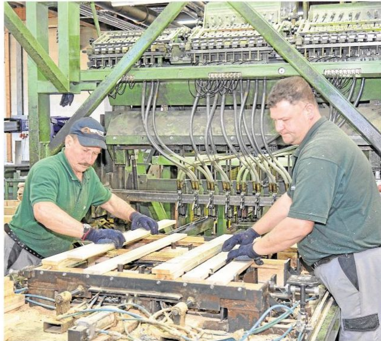
Arbeitsvorbereitung bei hapack: Maschinell werden Spezialpaletten sehr exakt gefertigt.
