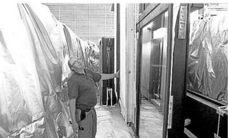
In den Hartenfelser Fertigungshallen werden die Einzelteile des Hauses luftdicht für den Transport auf hoher See verpackt.
